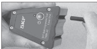
Fig 2 Montaggio o smontaggio delle guide a V
