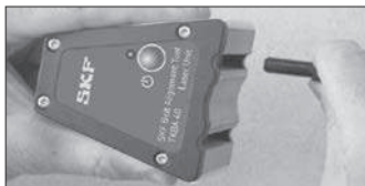
Fig 2 Instalación o retirada de las guías en V
