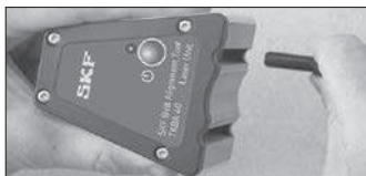
Рис 2 Установка и удаление V-направляющих
