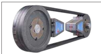
图4 激光单元装到皮带轮槽的示意图
